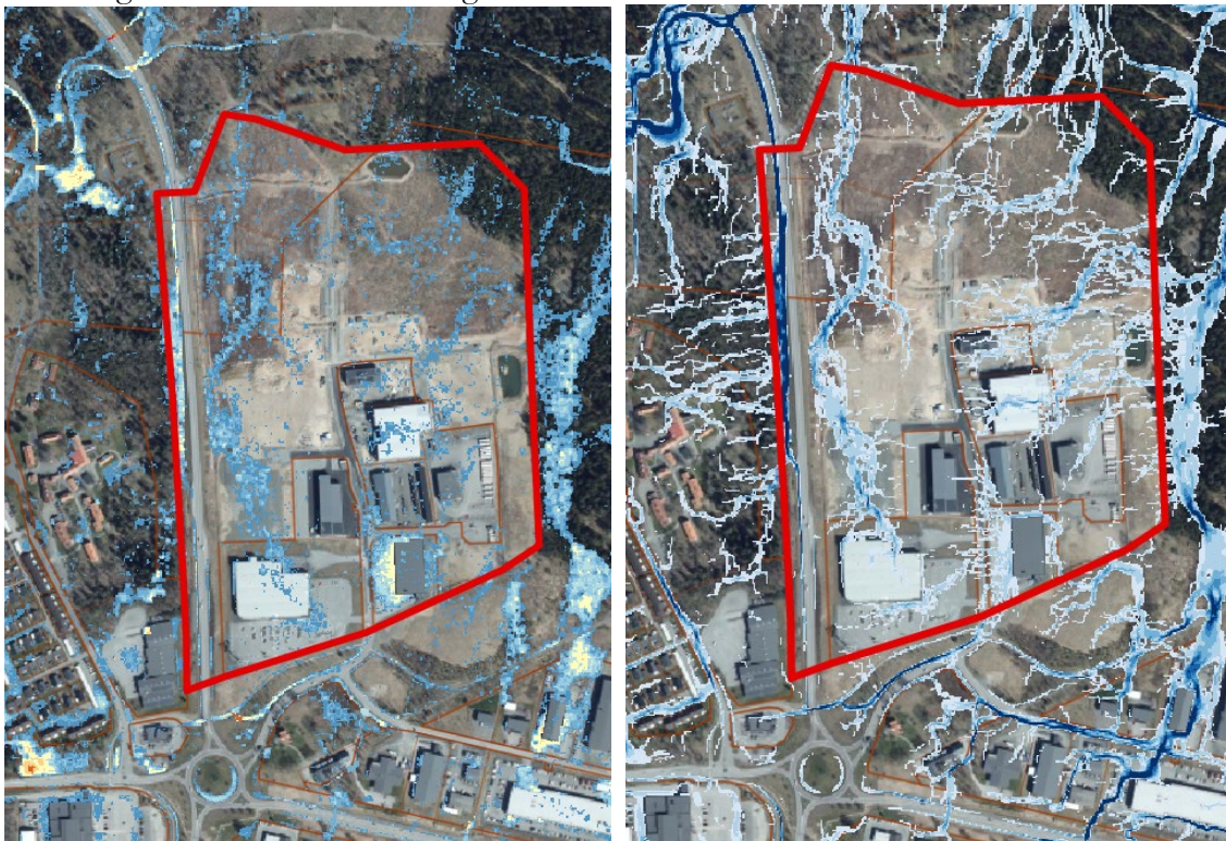
Kartan till vänster illustrera maximalt vattendjup (gul och röd färg indikerar stora djup) Kartan till höger illustrerar det maximala flödet, desto mörkare färg desto större flöden. Röd linje markerar planområdets avgränsning.
