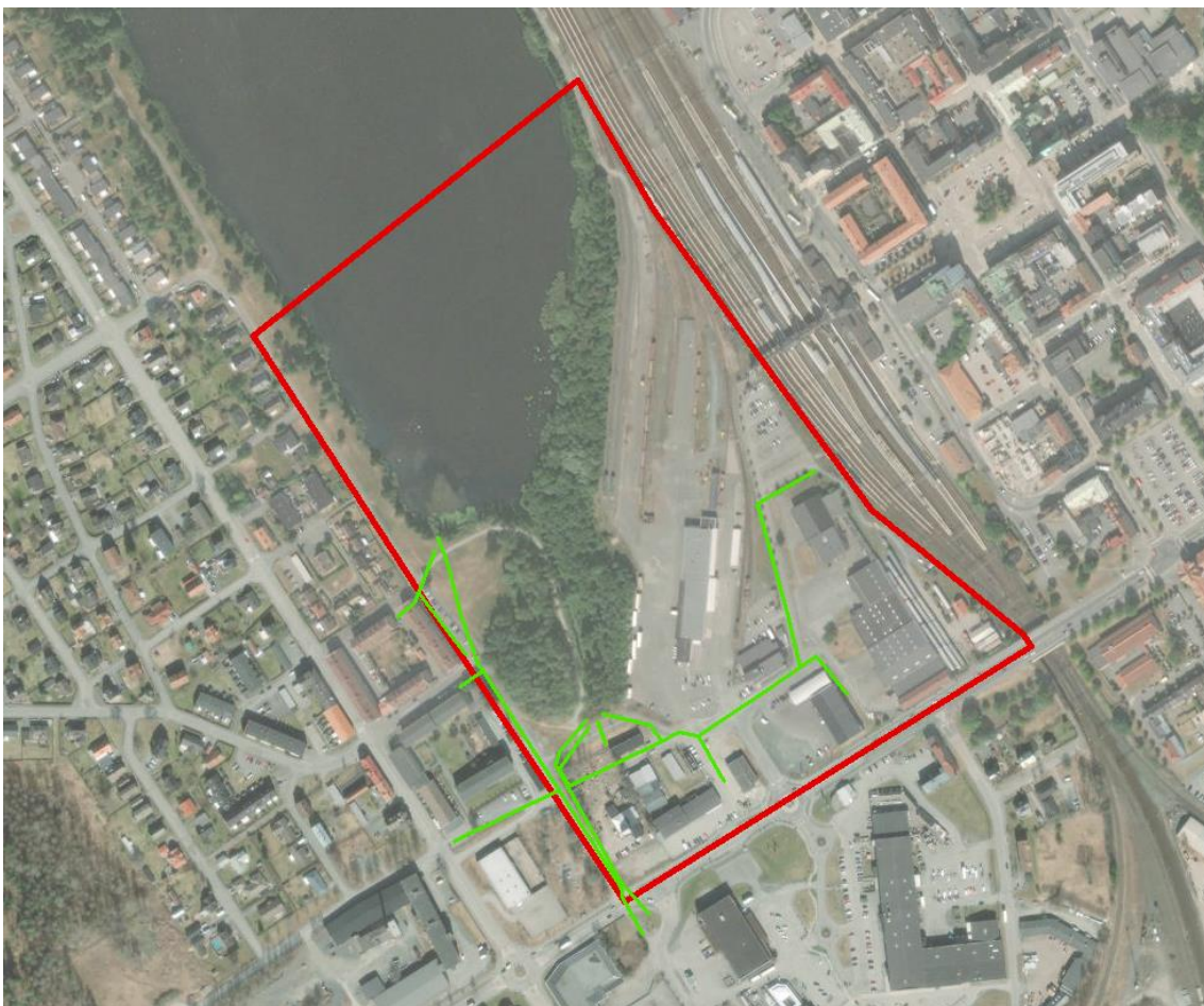
Figur 4. Ungefärlig placering av befintliga dagvattenledningar inom planområdet.
