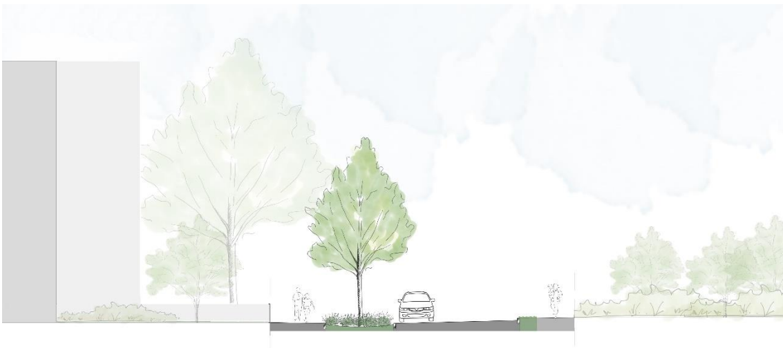
Figur 12. Principskiss för utformning av regnbädd intill väg (illustration: Tyréns AB).
